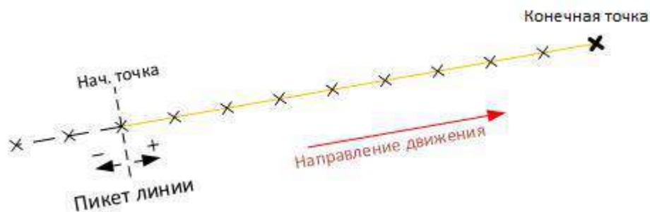
4. После разбивки первой точки линии, которую можно сохранить как вынесенную, следующую точку можно выбрать, используя выбор направления движения по линии следующими кнопками:
